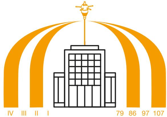
Le niveau de protection est déterminé à l'aide de la Norme NFC 17-102 éd. 2011, ou EN 62305-2, ou à l'aide du guide FDC 17-108. Si le site présente un risque pour l'environnement, le rayon de protection doit être réduit de 40%.
