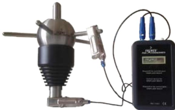
Test du paratonnerre démonté
