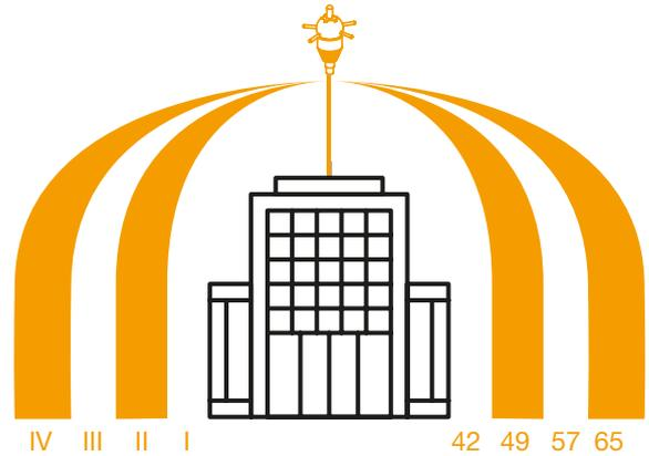
El nivel de protección se determina con la norma NFC 17-102 ed. 2011, o EN 62305-2, o con el guía FDC 17-108. Si existe un riesgo para el medio ambiente, el radio de protección debe ser reducido de un 40%. Para un nivel de protección I++ (Ver 5.2.3.5 NFC 17-102), el radio de protección debe también ser reducido de un 40%.
